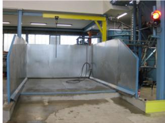
**b baurac Bohrschlamm-Aufbereitungsanlage**
